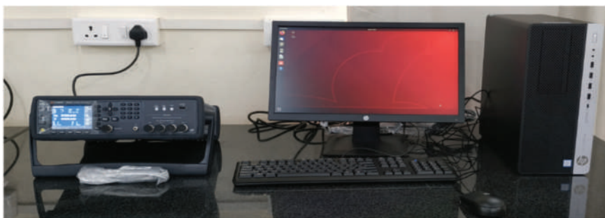
चित्र. 25 डाई एलेक्ट्रिक स्थिरांक माप के लिए एलसीआर मीटर
