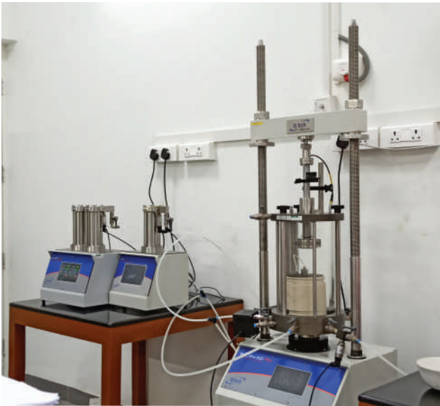
■ चित्र. 46 पारगम्यता माप के साथ स्वचालित तनाव-पथ स्थिर त्रिपक्षीय उपकरण
