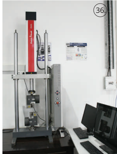
चित्र. 36 लोड फ्रेम में लगे इलेक्ट्रोमैकेनिकल 5kN एकचुएटर का दृश्य
