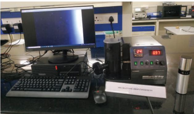
चित्र. 17 इलेक्ट्रॉन के चार्ज को निर्धारित करने के लिए मिलिकन का ऑयल ड्रॉप उपकरण
