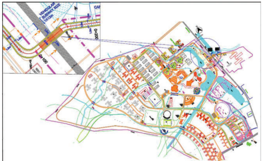
एनएच-565 के दोनों ओर परिसर के दो भूखंडों को जोड़ने वाले अंडरपास दर्शाने वाला प्रारूपिक प्लान
