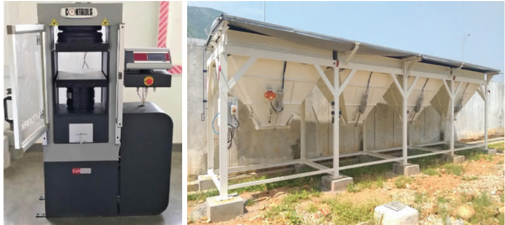
चित्र. 42 2000 kN लोड नियंत्रित संपीडन परीक्षण मशीन
