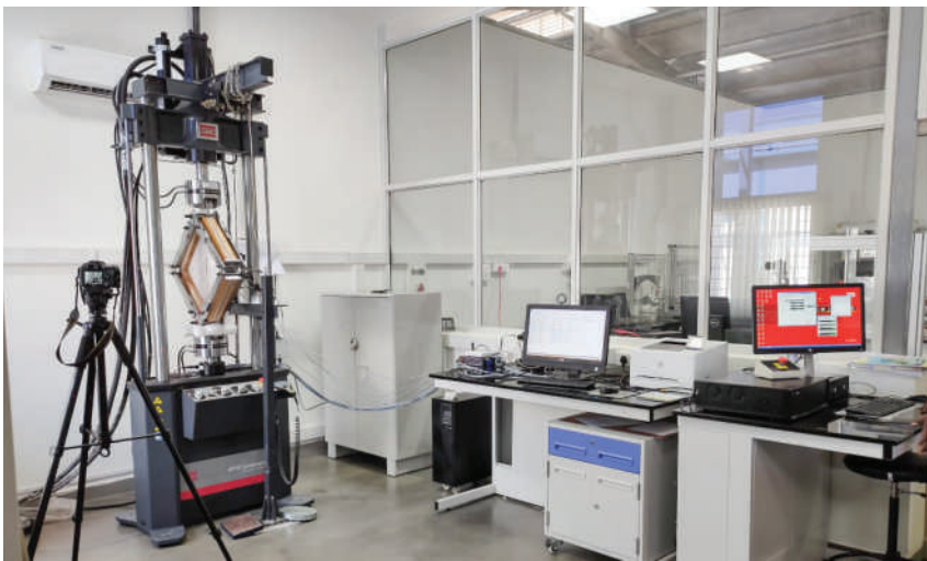
चित्र. 34 100kN यूटीएम और DAQ सिस्टम के साथ प्रयोगशाला का दृश्य
